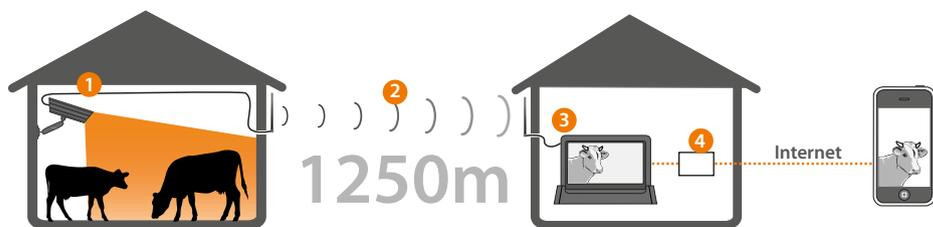
1. La cámara monitorea el ganado, la señal es transmitida a través del cable hacia la antena situada en la zona externa del edificio.
